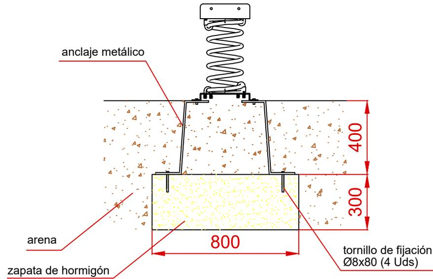
ESQUEMA DE CIMENTACIÓN EN HORMIGÓN
