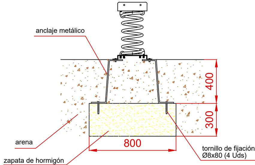
ESQUEMA DE CIMENTACIÓN EN HORMIGÓN
