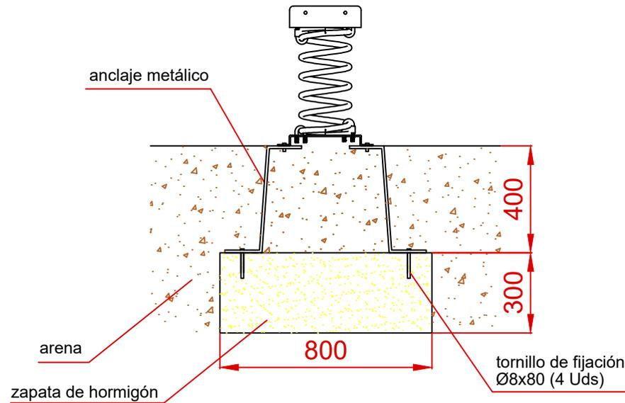
ESQUEMA DE CIMENTACIÓN EN HORMIGÓN
